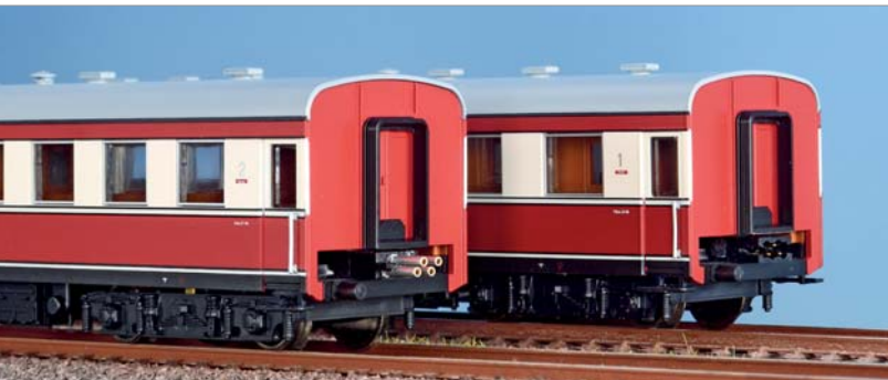
Die Steckkupplung zwischen den beiden Wagen des Triebzuges ermöglicht ein einfaches und komplikationsfreies Kuppeln.
